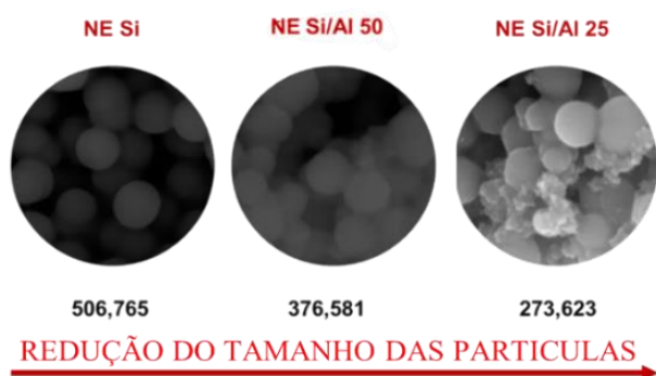
Figura 3. Representação da redução do tamanho das partículas em função da razão de Si/Al
